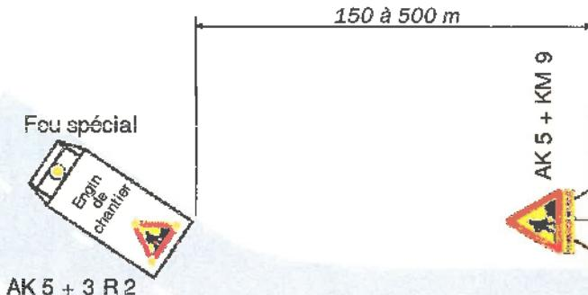
Ce schéma est inadapté aux chantiers à déplacement rapide
