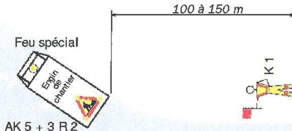
Ce schéma est inadapté aux chantiers à déplacement rapide
